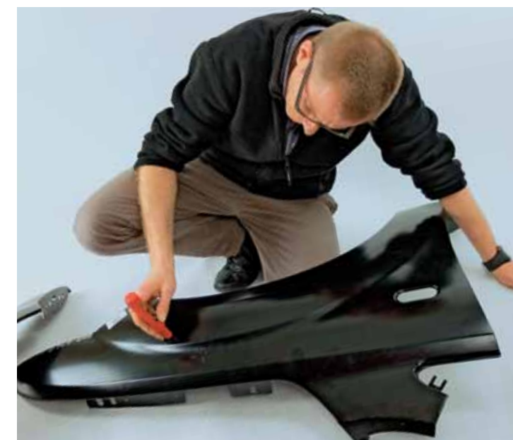
Warstwa zabezpieczenia antykorozyjnego na oryginalnej części była najgrubsza - nie licząc szpaczli na jednym zamienniku.
